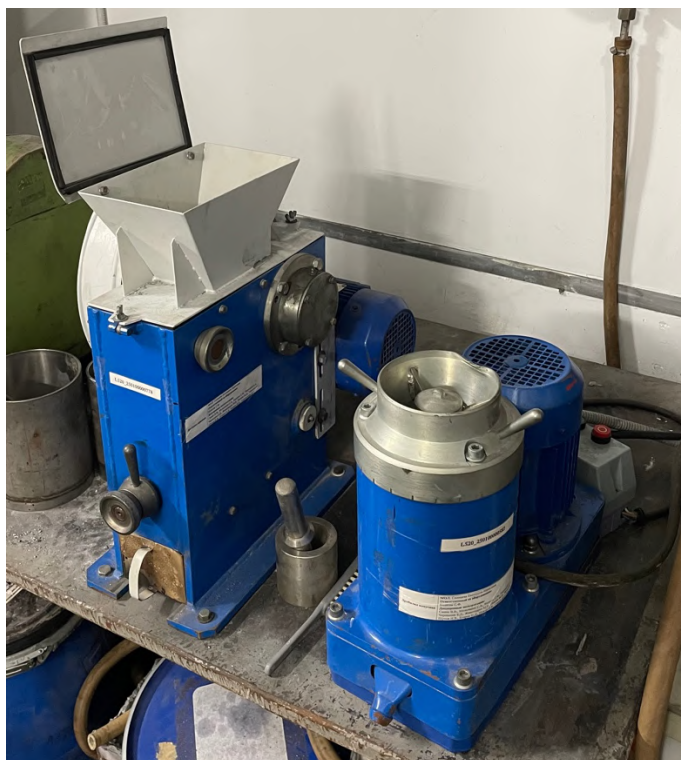
Рисунок 29 – Щековая (слева) и конусная инерционная дробилка (справа)
