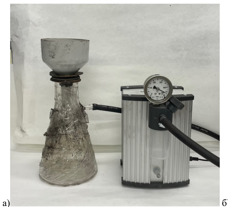
Рисунок 26 – Оборудование для фильтрации (а) и сушки (б) порошка гексаферрита стронция и спирта после тонкого помола
