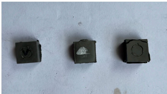
Рисунок 70 – Внешний вид «коричневых» деталей на основе гексаферрита стронция после дебиндинга при 40 °С (слева направо: образцы после дебиндинга в ацетоне, гексане, перхлорэтилене)
