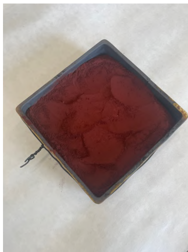
Рисунок 23 – Гематит и карбонат стронция в тигле до ферритизации
