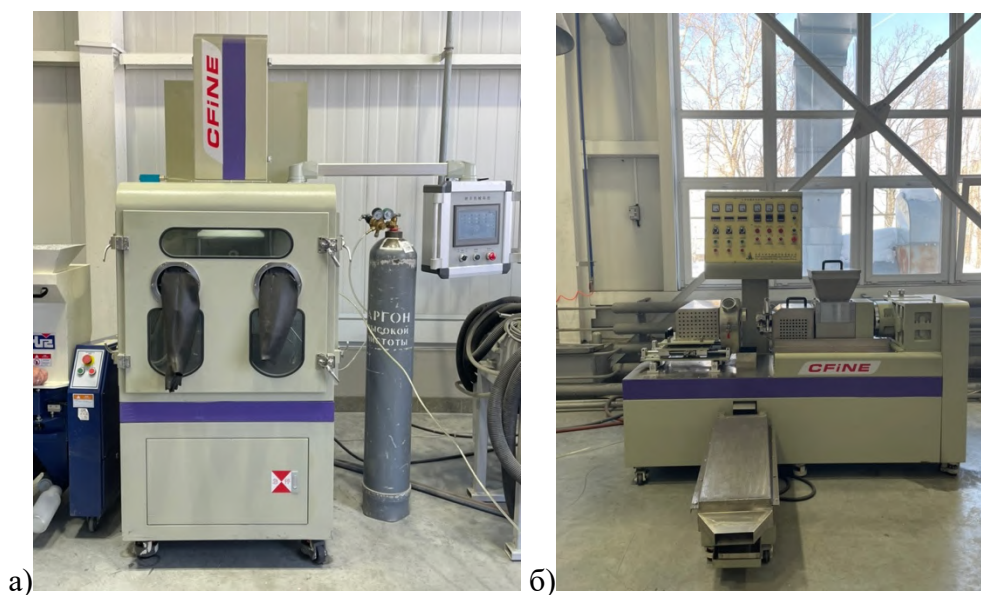
Рисунок 40 – Система для смешивания порошка и связующего в атмосфере инертного газа (а) и гранулятор CFine (б)
