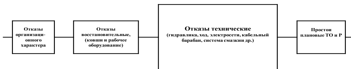
Рис.3.17. Обобщенная структурная блок-схема экскаваторов РС 5500Е
