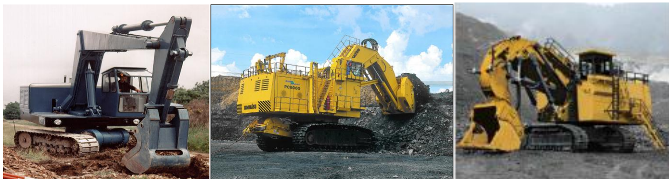
Рис. 1.1. Гидравлические экскаваторы: а – первая в мире обратная гидравлическая лопата компании KMG с ковшем 0,5 м 3 ; б - прямая лопата РС 8000 ковшем 42 м 3 ; в – прямая гидравлическая лопата «TriPower» (O&K) модель CAT 6050
