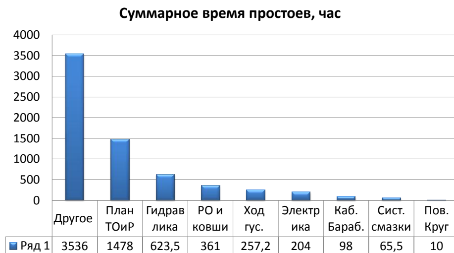
Рис. 3.21. Группировка 9-ти категорий оборудования экскаваторов РС 5500 по длительности суммарного времени простоев, час
