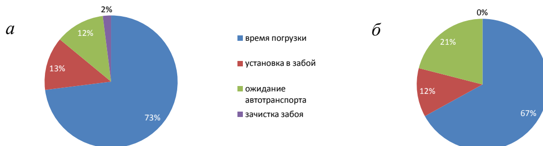
Рис. 3.3. Баланс рабочего времени при выполнении технологических операций гидравлическими экскаваторами РС 3000D: а – прямой; б – обратной лопатой; 1 – чистое время погрузки; 2 – переезды связанные с установкой в забой; 3 – ожидание автотранспорта; 4 – зачистка забоя.
