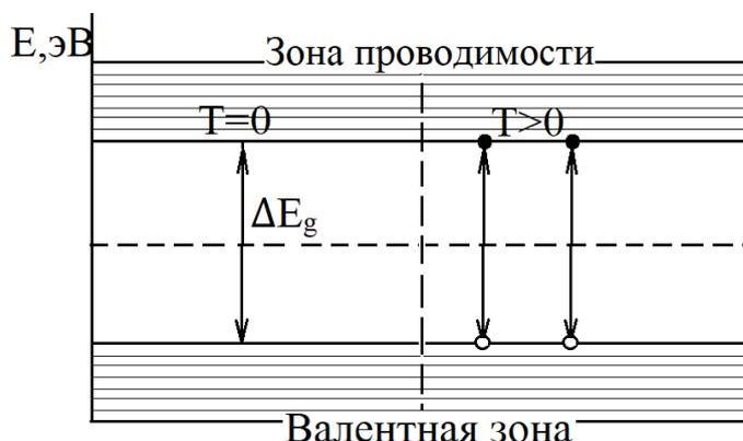
Рис. 5.1.9. Схематическое изображение ширины запрещенной зоны и
