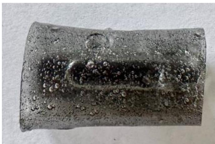
***Рис. 4.3.2. Полимерная пленка на основе поливинилового спирта и УНТ***
