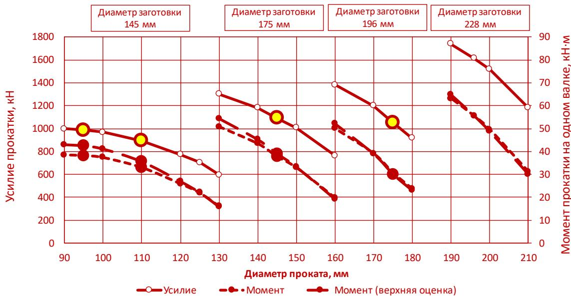
Рисунок 6.11 – Результаты расчёта усилия и момента прокатки заготовок из стали 08Х18Н10Т на специализированной клети РСП.
