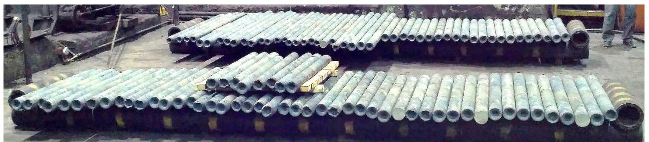
Рисунок 2.5 – Общий вид деформированных на стане РСП МИСиС-130Т заготовок.
