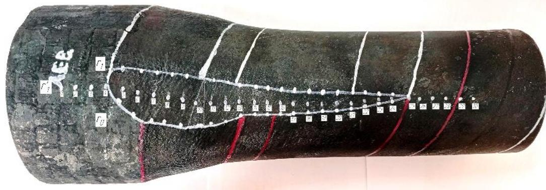
Рисунок 6.4 – Недокатанный образец заготовки  $\varnothing 145 \rightarrow \varnothing 105$  мм на специализированной клети РСП (сталь СТ0, вариант калибровки 2).
